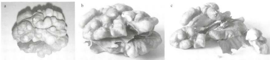
a. 压缩前; b. 压缩变形; c. 压缩后
