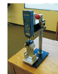
TMS-BFG 手动型嫩度仪；主要用于肉制品嫩度的测试
