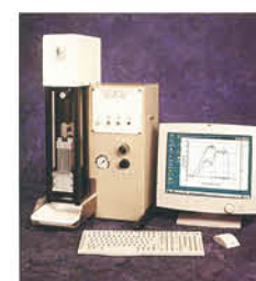
TMS-2000大型食品物性分析仪；可检测力量范围大，运行稳定精确
