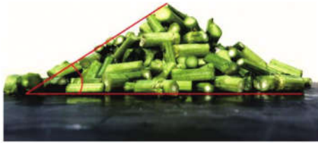
图 1 饲料油菜茎秆颗粒堆积试验
