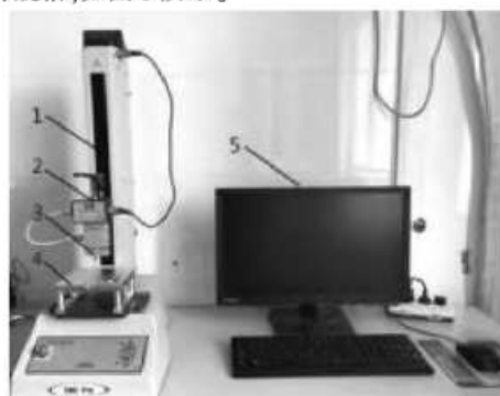
1.机架;2.加载装置附带力感单元;3.穿刺针头;4.底座;5.计算机。
