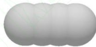
图2 硬颗粒饲料离散元几何模型
